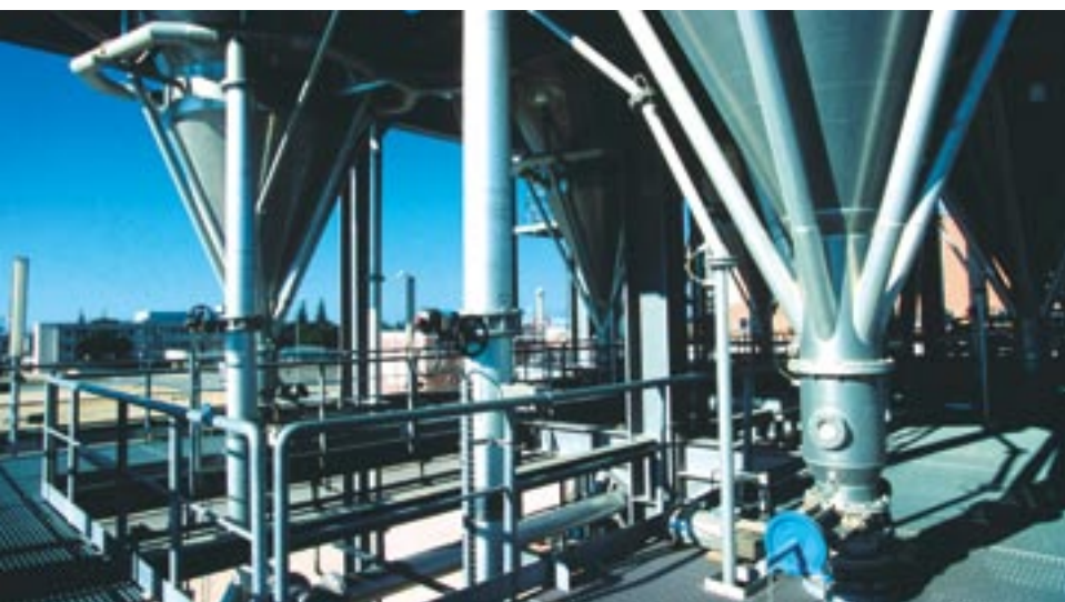
Mischrohre und Mischkammern eines Zeppelin Multi-Pipe-Mischers mit integriertem Belüftungsring zur Entgasung.
