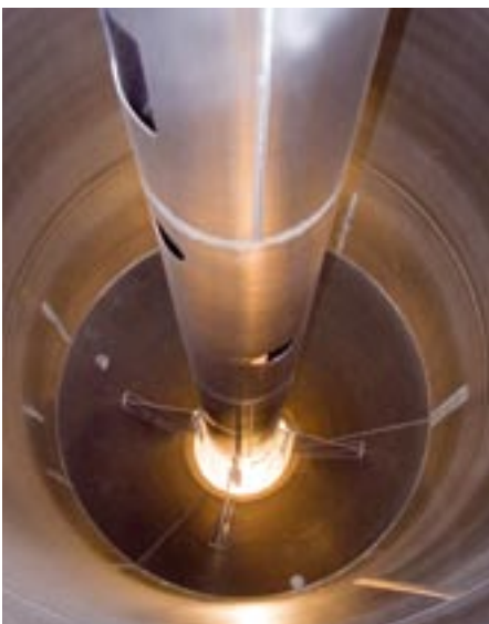
Bild links: Centro-Blend Innenansicht mit eingebautem Mischrohr.
